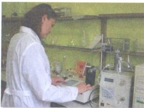
Многофункциональный анализатор «Флюорат 02-2М» с хроматографической приставкой «ВЭЖХ-3» предназначен для измерения массовой концентрации органических и неорганических примесей в почве, воде, кормах, удобрениях, продуктах питания, технических материалах после перевода примесей в раствор.
