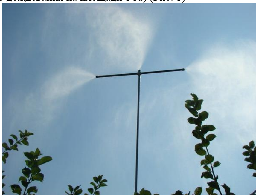
Рисунок 1 – Система аэрозольного увлажнения КАУ-1М, разработанная ВНИИ «Радуга»
