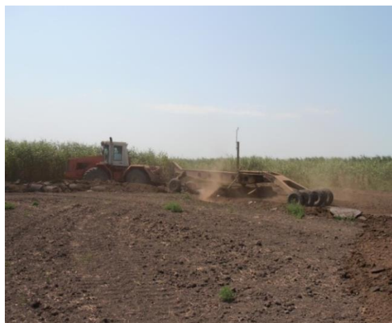
Рис. 2. Выравнивания угла чека клин-планировщиком
