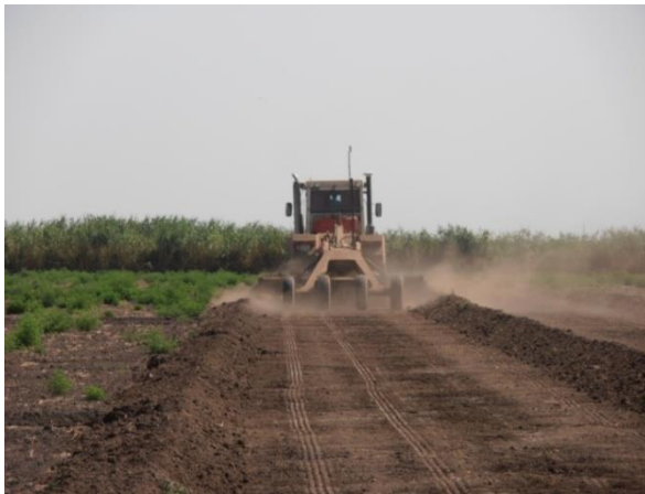
Рис. 3. Образование насыпных валиков после прохода клин-планировщика
