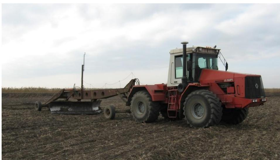
Рис. 2. Клин-планировщик при производстве работы на чеке.
